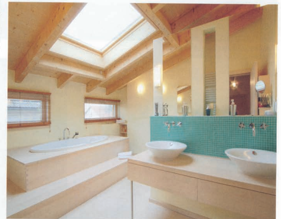
Für den Boden im Bad wurden massive Ahorndielen verwendet; der Waschtisch dient als Raumteiler, dahinter verbirgt sich eine großzügige Dusche
