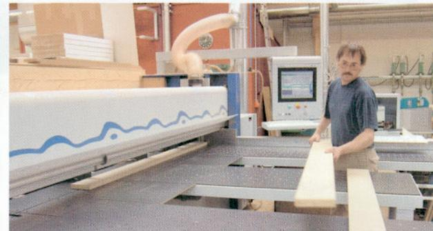
Flexibler Zuschnitt: Holzma-Plattensäge mit CADmatic-Steuerung und Etikettendrucker
