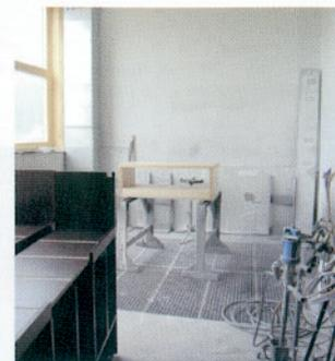
... und der Lackierraum mit Unterflurabsaugung. Verarbeitet wird nur PUR-Lack von Zweihorn
