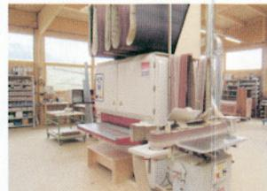
Für hochwertige Massivholz- und Furnieroberflächen sorgen die Breitbandschleifmaschine...
